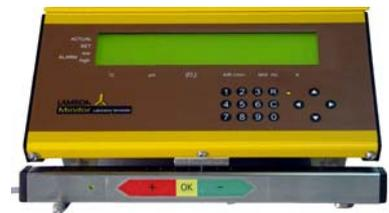
Das optionale **Wägemodul** wird unter den vorderen Teil des Reaktors gestellt und an den X-Kanaleingang angeschlossen.
